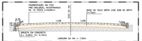
02.07 DETALHE - SEÇÃO TRANSVERSAL DA VIA
